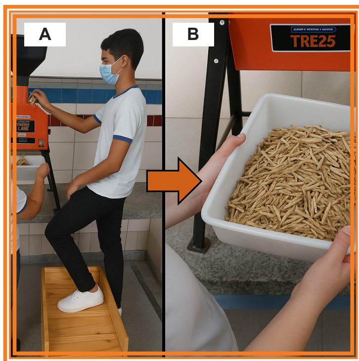
Figura 3 – Trituração e obtenção do resíduo do coqueiro. A. Estudantes operando o triturador elétrico modelo TRE25 no Laboratório de Ciências. B. Detalhe do resíduo triturado, evidenciando a granulação obtida.
