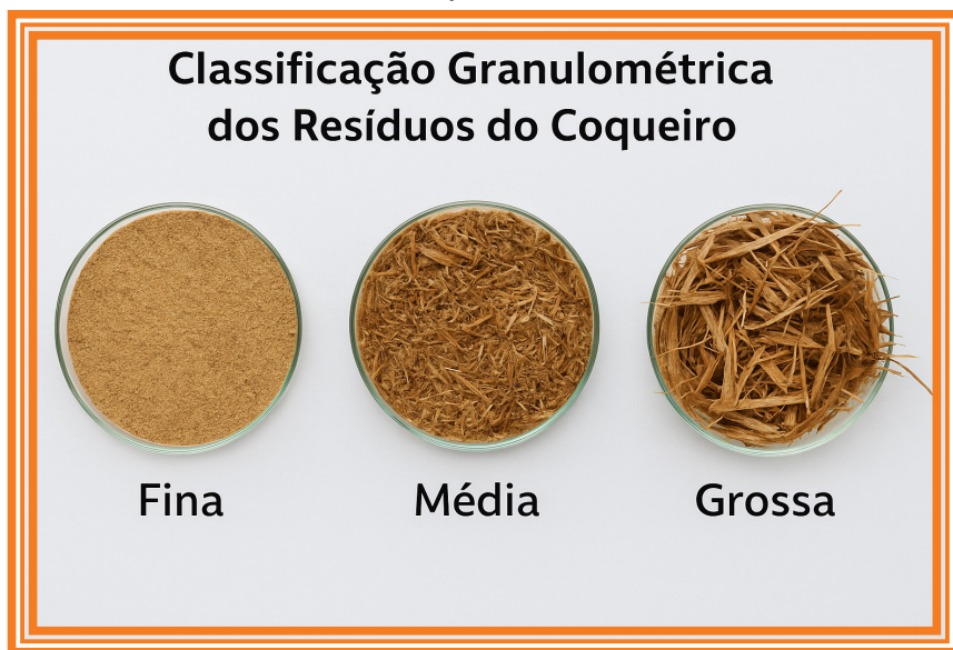
Figura 4 – Classificação granulométrica dos resíduos triturados. Amostras dos resíduos do coqueiro classificados em três granulometrias: fina (3 mm), média (5 mm) e grossa (10 mm), utilizadas na formulação dos compensados.
