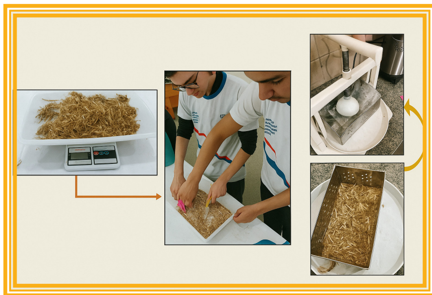
Figura 5 – Mistura e prensagem dos compensados sustentáveis. Sequência do processo de preparação dos compensados: pesagem do resíduo, homogeneização com cola PVA e prensagem manual da mistura em molde.
