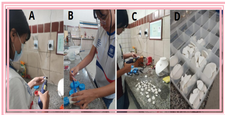
Figura 3 – Primeiras etapas da confecção. A – Lixamento. B – Desenformagem. C – Perfuração. D – Peças tratadas.
