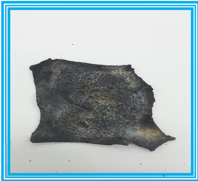
Figura 21 - Material obtido sem controle de temperatura.
